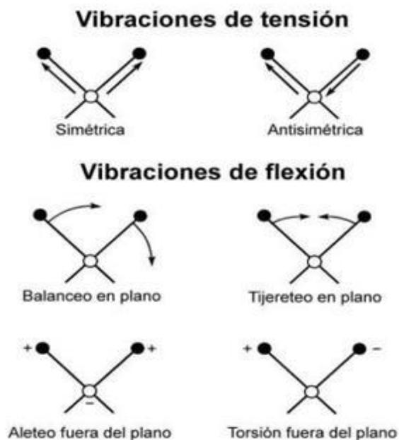
**Figura 2.7.** Tipos de vibraciones moleculares.
