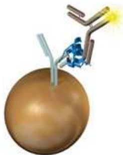
Figura 18. Esquema de un inmunoensayo usando nanopartículas funcionalizadas con moléculas fluorescentes.
