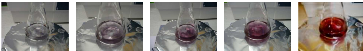
Figura 24. Proceso de síntesis de nanopartículas de oro por el método de reducción química.
